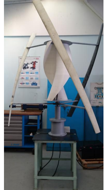
Fig. 7. Turbina eoliană cu rotoare Savonius și Darrieus
