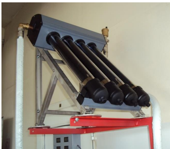
Fig. 3. Mini panou termic solar
