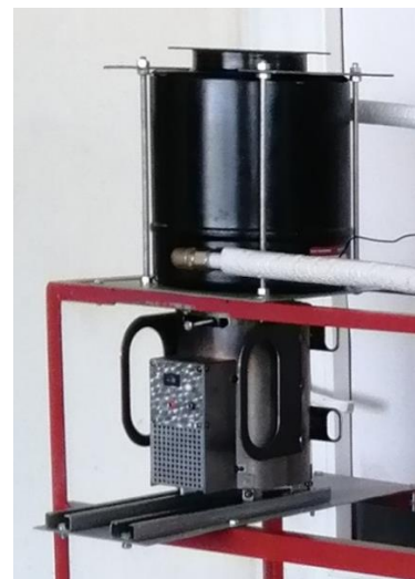
Fig. 4. Modul energetic pentru biomasă
